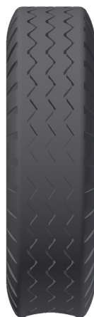
Falta de pressão
